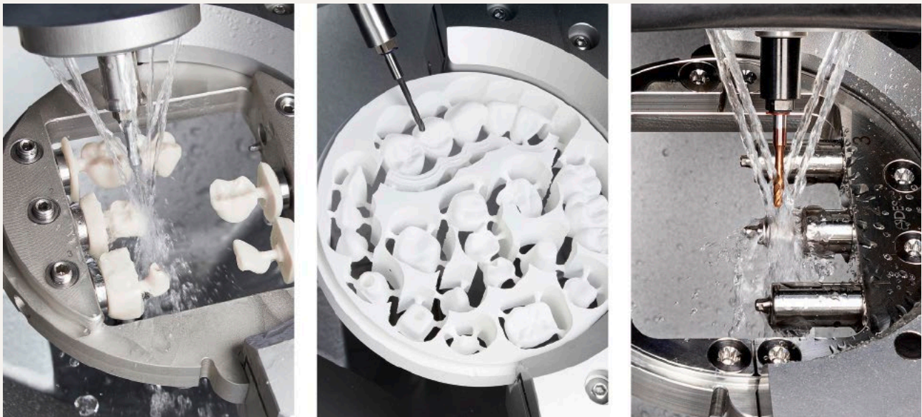
▲ Große Anwendungs- und Materialvielfalt beim Fräsen: Mit der vhf R5 lässt sich dank der directclean Technology ohne Umrüstarbeiten beliebig zwischen Nass- und Trockenbearbeitung wechseln. Hier (von links): Nassschleifen von Glaskeramik, Trockenfräsen von Zirkon, Nassfräsen von Titan.
