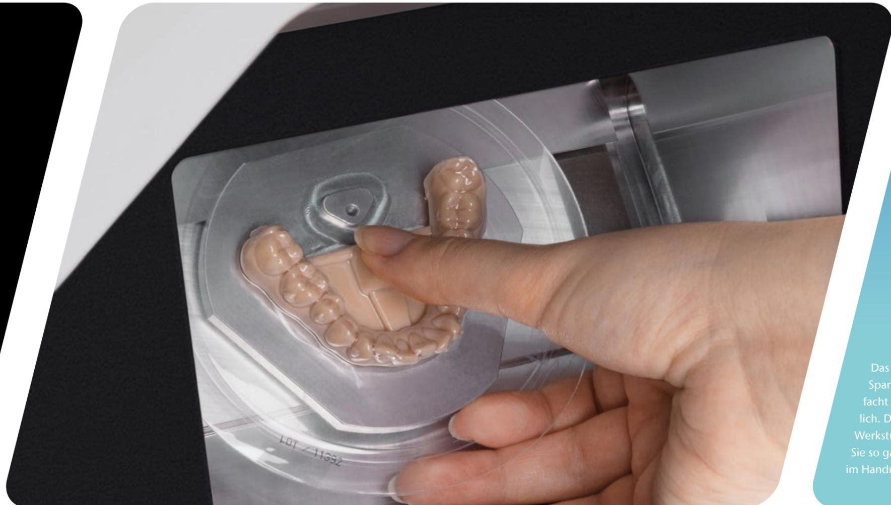
Das werkzeuglose Spannsystem vereinfacht Ihre Arbeit zusätzlich. Dank schnellem Werkstückwechsel fertigen Sie so ganze Aligner-Serien im Handumdrehen.
