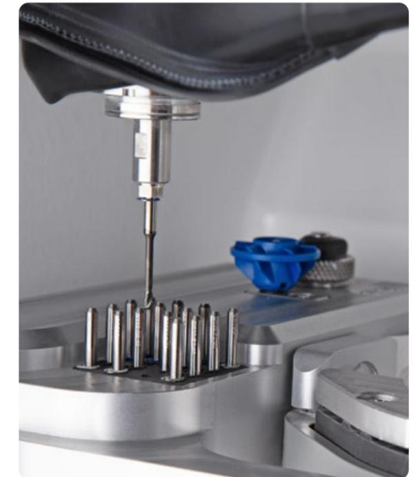
Der automatische Werkzeugwechsler bietet Platz für 16 Standardwerkzeuge sowie ein airtool.
