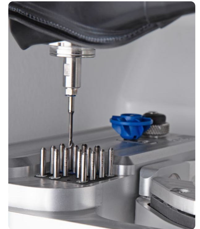
El almacén de herramientas automático tiene espacio para 16 herramientas estándar y una airtool .
