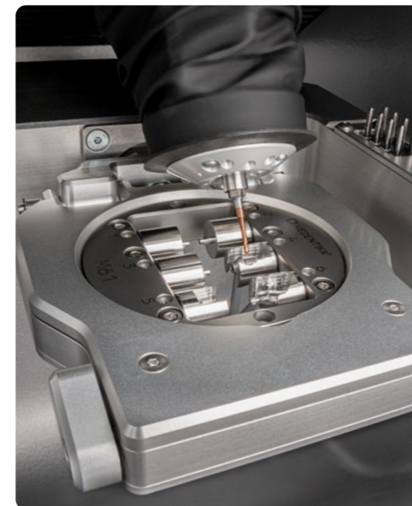
Avec les supports adaptés, vous fabriquez aussi facilement des piliers préfabriqués en CoCr que des matériaux en blocs.
