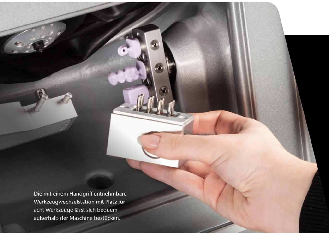
Die mit einem Handgriff entnehmbare Werkzeugwechselstation mit Platz für acht Werkzeuge lässt sich bequem außerhalb der Maschine bestücken.
