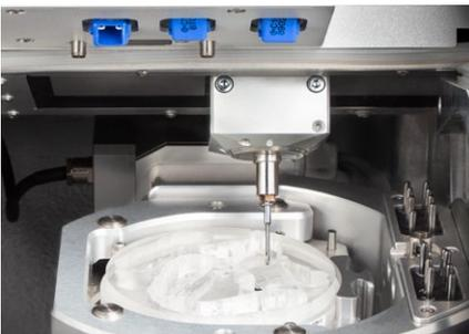
三个内置电离器显著减轻 S5 的清洁工作量，因为它能中和例如 PMMA 中塑料切屑的静电荷。空气喷嘴在此发挥辅助作用，负责分配工作舱内的电离空气。
