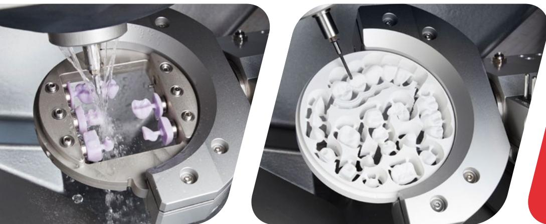
Volle Material- und Indikationsvielfalt – auch mit manuellem Rohlingswechsel: Die **directclean** Technology ist mit an Bord und erlaubt dank ihres genialen Arbeitsraum-Trocknungssystems den beliebigen Wechsel zwischen Nass- und Trockenbearbeitung.
