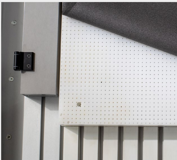
Die Vakuum-Elemente mit Lochraster sind auf einem T-Nuten-Tisch fixiert.
