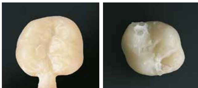
Abb. 4: Eine Krone direkt nach dem Fräsen (links) bzw. Drucken (rechts). Beim Fräsen bleibt ein Haltesteg stehen, der vergleichsweise unauffällig seitlich am Zahn angebracht wurde. Er lässt sich gut von Hand entfernen. Die Stützstruktur des 3D-Drucks besteht aus mehreren dünneren Stegen, die sich häufig direkt auf der Kaufläche befinden. Deren Entfernung gestaltet sich deutlich schwieriger und die feinen Details einer aufwendig konstruierten Kaufläche können hierbei wieder verloren gehen. Reste des Druckharzes sind hier noch als weiße Schicht erkennbar.
